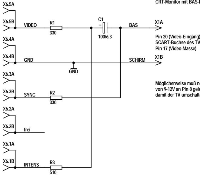
Möglicherweise muß noch eine Schaltspannung von 9-12V an Pin 8 gelegt werden, damit der TV umschaltet.
